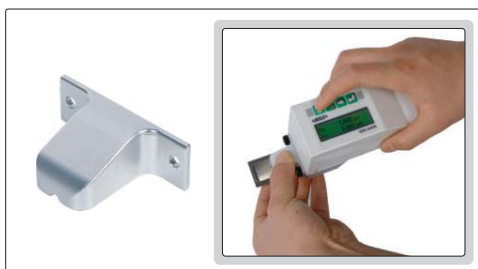
Peças pequenas podem ser medidas diretamente sobre o sensor
