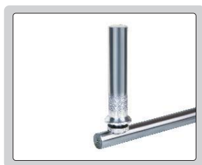
ensaio em superfície cilíndrica (usando a base de apoio em "V")
