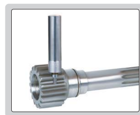
ensaio em local estreito (usando sem a base de apoio)
